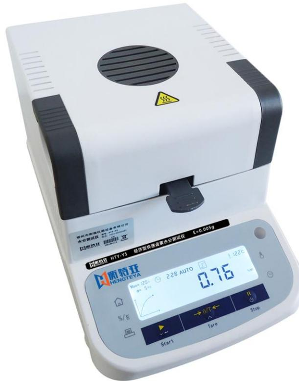
HTY-Y5 经济型快速卤素水分测试仪，是衡特亚产品线的延伸，采用环形石英钨卤红外线环形灯加热方式可直接从物质内部加热，大大缩短了烘干的时间，而且还具有加热均匀、清洁、效率高、节约能源的优点，钨卤环形灯是在红外线灯中注入碘或溴等卤素气体，在高温下，升华的钨丝与卤素进行化学作用，升华的钨会重新凝固在钨丝上，形成平衡的循环，避免钨丝过早断裂。因此钨卤灯比普通红外线灯更长寿。
